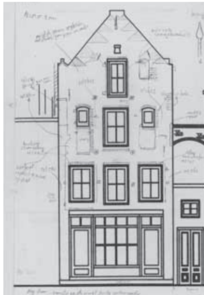
▲ De werktekening die tijdens de documentatie is vervaardigd o.b.v. een bestaande opmeting. Een snelle documentatie is zo mogelijk. (Afb.16)
